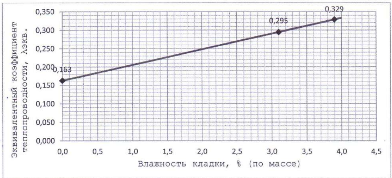
Рисунок 2. График зависимости коэффициента теплопроводности от влажности кладки.
