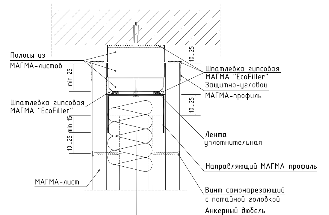
Эластичное примыкание с учетом требований звукоизоляции
